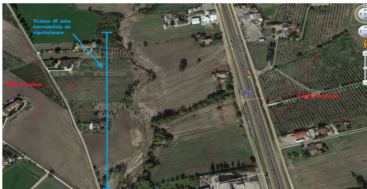
Tratto di alveo da ripristinare; sono evidenti le forme erosionali dei versanti per rill e gully.
