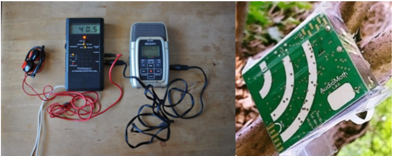
Figura 34 – Strumentazione per i rilievi ultrasonori: a sinistra bat detector manuale D240 X Pettersson Elektronik e registratore digitale Zoom H2; a destra Audiomoth 1.2.0
