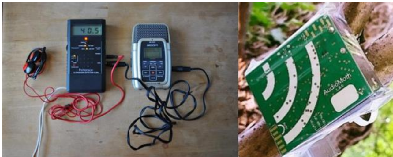
Figura 59 – Strumentazione per i rilievi ultrasonori: a sinistra bat detector manuale D240 X Pettersson Elektronik e registratore digitale Zoom H2; a destra Audiomoth 1.2.0.
