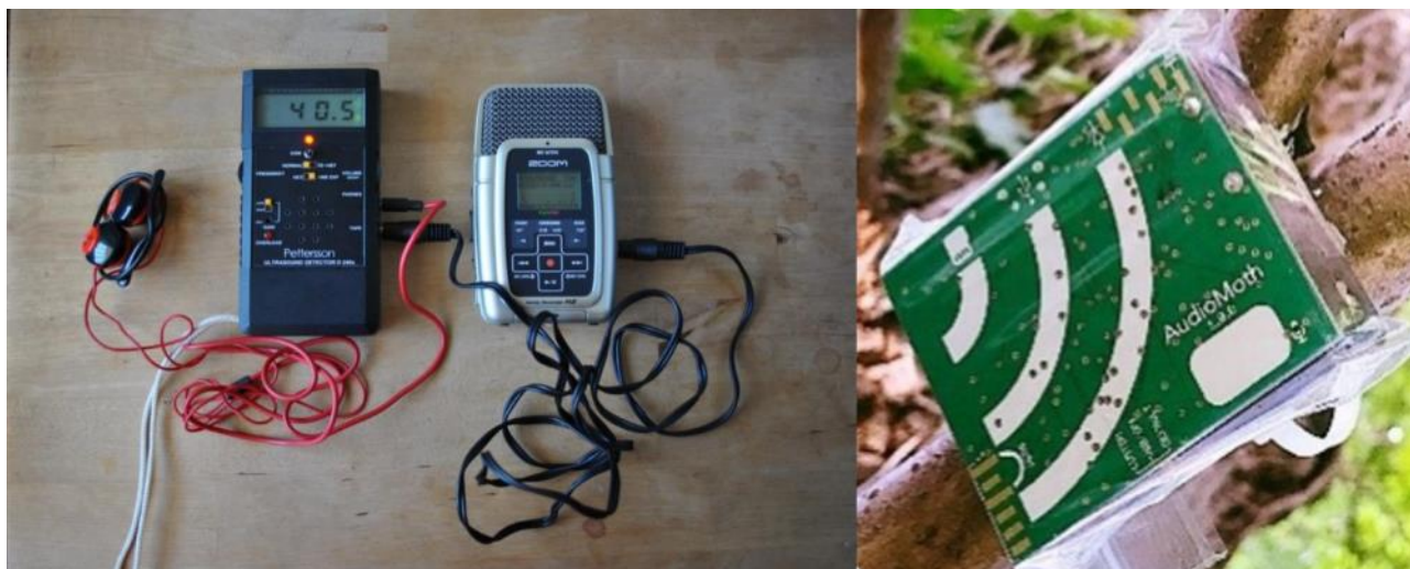
Figura 27 – Strumentazione per i rilievi ultrasonori: a sinistra bat detector manuale D240 X Pettersson Elektronik e registratore digitale Zoom H2; a destra AudioMoth 1.2.0
