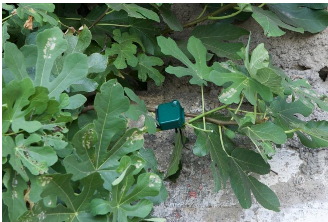
Figura 13 Bat detector su punti di ascolto automatici.
